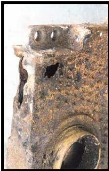
**DAMAGED BOILER SECTION FROM SCALE**
